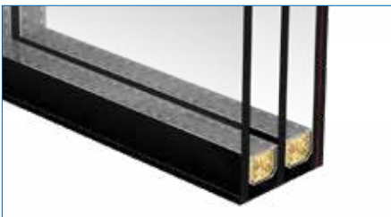
3-szybowy pakiet 4/14/4/14/33.1 CIEPŁO I BEZPIECZEŃSTWO
