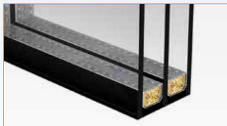
3-szybowy pakiet 4/14/4/14/4 PODWYŻSZONA IZOLACJA TERMICZNA
